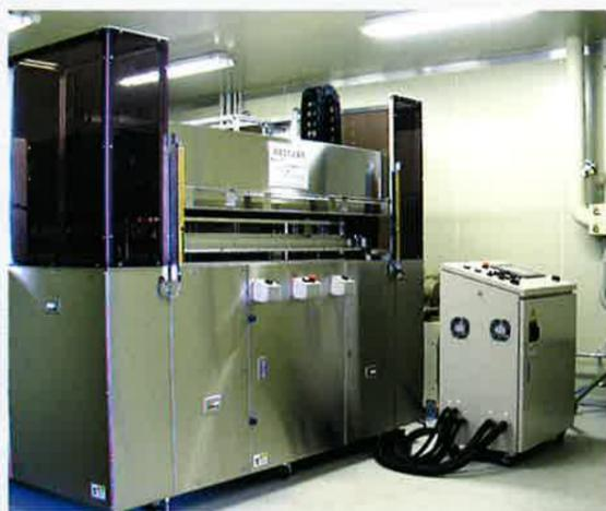
真空断熱材用高真空封止装置
